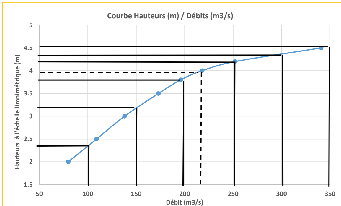
Figure 1 : exemple de pas de hauteurs pour des intervalles de débits constants (station de Brienon sur Armançon)
